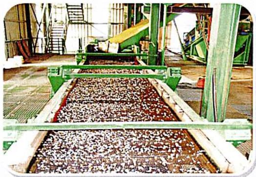
Die im Tagebau in Bottrop-Kirchhellen gewonnenen Quarzsande und Quarzkiese werden der Nassaufbereitung zugeführt, gewaschen bzw. von Schlammstoffen befreit und in Korngruppen klassiert. Die Reinigung und Klassierung der Quarzsande und -kiese erfolgt mit Brauchwasser aus der betriebseigenen Wasserversorgung über Siebanlagen und einen Turbowasher.
