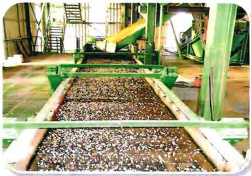
Siebmaschine in der Nassaufbereitung
